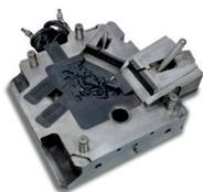
Il rivestimento **Kronos**, a base di **AlCrN**, è la soluzione Lafer per la pressofusione di alluminio, zama e magnesio. La sua composizione è l'ideale per contrastare la **metallizzazione** e permette di combinare l'**elevata resistenza all'usura**, propria dei rivestimenti contenenti cromo, con quella alle alte temperature, tipiche dei rivestimenti contenenti alluminio.
